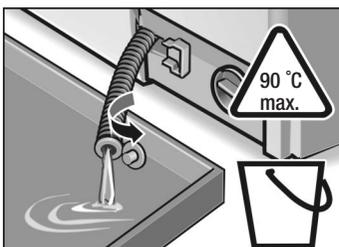
Verschluss-Kappe abziehen und Waschlauge in bereitstehendes Gefäß abfließen lassen.
