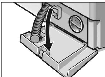
Entleerungsschlauch aus der Halterung nehmen und aus dem Gehäuse ziehen.
