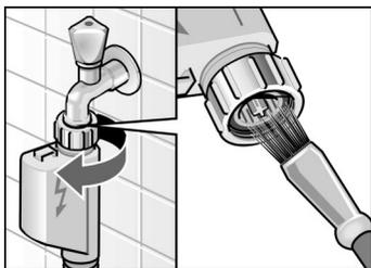
Wenn kein oder nicht genügend Wasser in die Waschmaschine einläuft. Anzeigelampe „Waschen“ blinkt.
