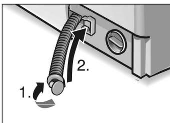
Verschluss-Kappe aufdrücken (1.) und Entleerungsschlauch in die Halterung einsetzen (2.).
