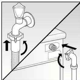
接駁要求水壓至少為1 bar的標準冷水管 (在水龍頭開啓時，水流速度必須約為每分鐘 8 公升)。
