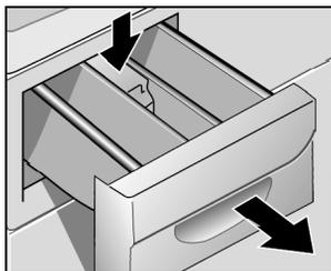
1. 將洗滌劑盛格移取出。壓下在衣物柔順劑格後方的把手後，將槽壓下後抽離。將把手往下按住，將其拉出洗衣機。
