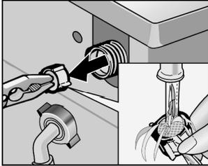
如流入洗衣機的水量不足，便必須清洗入水喉過濾網。過濾網位於入水喉與自來水掣之間，也是在機背面的電磁閥連接處。
