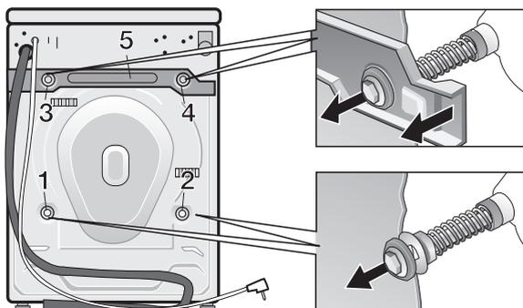
Os componentes da segurança de transporte no interior da máquina caem para o chão por baixo da máquina.
