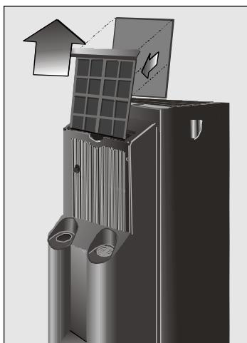
O aparelho dispõe de um filtro básico de ar, que é necessário limpar à medida que passa o tempo. Para isso, basta lavá-lo com água corrente, secá-lo e torná-lo a instalar.
