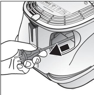
Netzanschlusskabel am Stecker greifen, auf die gewünschte Länge herausziehen und Netzstecker einstecken.
