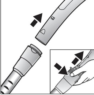
Zum Lösen der Verbindung Entriegelungshülse drücken und Handgriff herausziehen.
