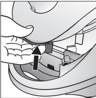
Staubraumdeckel durch Betätigung des Verschlusshebels in Pfeilrichtung öffnen.
