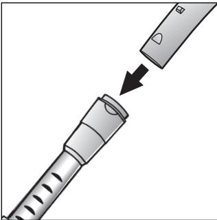
Handgriff bis zum Einrasten in das Teleskoprohr schieben.
