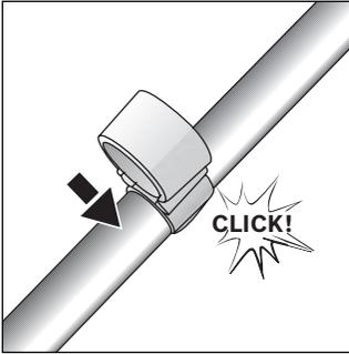
Zubehörträger am Saugrohr befestigen und das Kombi-Zubehör von oben einschieben.
