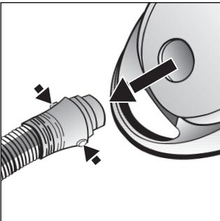
Beim Entfernen des Saugschlauches beide Rastnasen zusammendrücken und Schlauch herausziehen.
