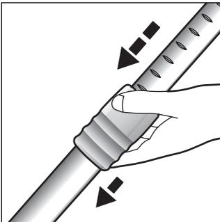
Durch Drücken der Schiebemannschette in Pfeilrichtung Teleskoprohr entriegeln und zusammenschieben.
