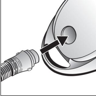
Saugschlauchstutzen in die Saugöffnung einrasten.
