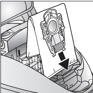
Neuen Filterbeutel in die Halterung einlegen und Staubraumdeckel schließen.
