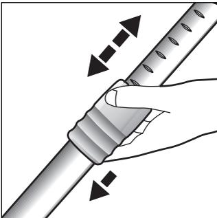
Durch Drücken der Schiebemannschette in Pfeilrichtung Teleskoprohr entriegeln und gewünschte Länge einstellen.
