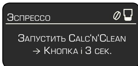
Calc'n'Clean объединяет функции удаления накипи и очистки. Если приближается время выполнения обеих программ, полностью автоматическая кофе-машина эспрессо автоматически предлагает эту сервисную программу.
