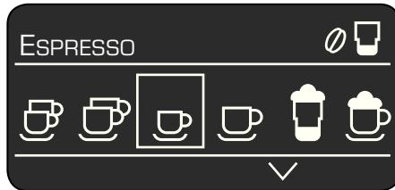
In de regel 'status' **5a** van het display wordt de naam van de drank en de ingestelde sterkte, bijv.  $\emptyset\emptyset$ , en hoeveelheid, bijv.  $\square$ , vermeld. In de regel 'keuze' **5b** verschijnen symbolen voor de drankkeuze.
