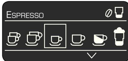
In de regel 'status' **5a** van het display wordt de naam van de drank en de ingestelde sterkte, bijv.  $\emptyset\emptyset$ , en hoeveelheid, bijv.  $\square$ , vermeld. In de regel 'keuze' **5b** verschijnen symbolen voor de drankkeuze. De pijltjes in de regel 'navigatie' **5c** geven aan in welke richting er zich nog menu-items bevinden.
