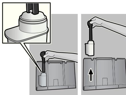
**Opmerking:** Door het filter **34** te spoelen, is tegelijk ook de instelling voor de indicatie van de filtervervanging geactiveerd.
