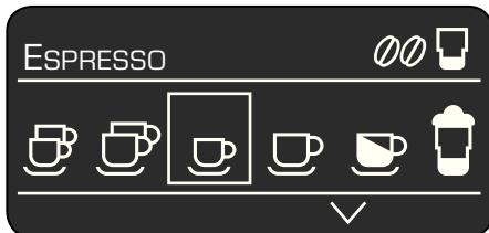
In der Statuszeile **5a** des Displays **5** wird der Name der Getränkeart sowie bei Kaffeetränken die Einstellung Stärke z.B. **00** und Menge z.B. **◻** angezeigt. In der Auswahlzeile **5b** werden Symbole für die Getränkeauswahl dargestellt. Die Pfeile in der Navigationszeile **5c** zeigen an, in welcher Richtung sich noch Menüebenen befinden.
