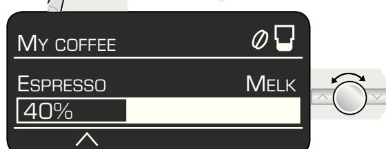
Naast de koffiesterkte en hoeveelheid kan voor de eigen koffie-instelling MY COFFEE ☺+ nog de mengverhouding espresso-melk worden gekozen. De instelling kan in stappen van 20% worden gewijzigd door aan de draaiknop 6 te draaien.
