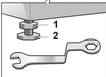
Waschmaschine mit Hilfe der vier verstellbaren Gerätefüße und einer Wasserwaage ausrichten:
