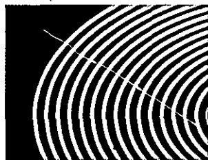
Rasguños debidos a granos de sal, azúcar o arena, o a los fondos de recipientes rugosos.
