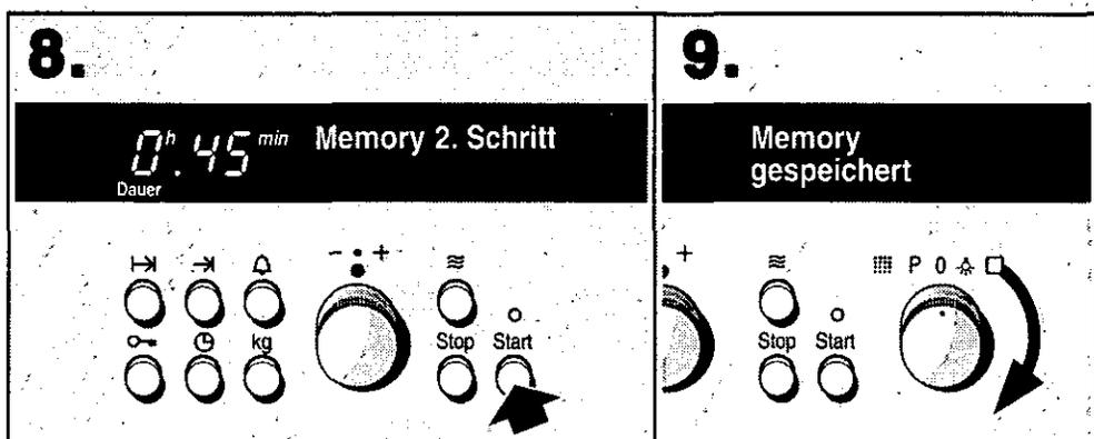
**8.** Taste Start drücken. Damit speichern Sie den "1. Schritt". Ein "2. Schritt" wird angeboten. (Stellen Sie ein wie in Punkt 4 bis 8). Sie können insgesamt drei Schritte einstellen und speichern. "Memory voll" sagt Ihnen, dass keine Einstellungen mehr gespeichert werden können.
