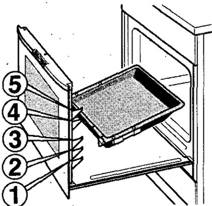
Das **Zubehör** wird in die Haken links und rechts am Backwagen eingehängt. Sie können das Zubehör in 5 verschiedenen Höhen einhängen.
