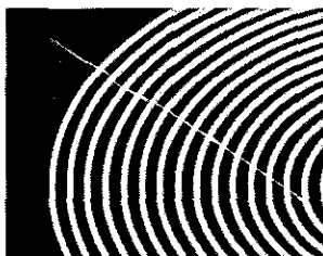
Graffi , a causa di sale, zucchero o di granelli di sabbia, oppure a causa di fondi di pentole ruvidi.
