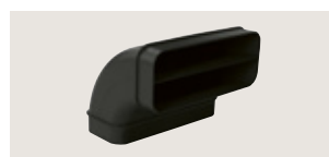
HZ9VDSB2 90°-Flachkanalbogen vertikal (großer Radius, ≥70 cm Arbeitsplattentiefe)
