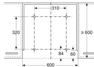
Montage Flachschirmhaube mit Absenkrahmen
