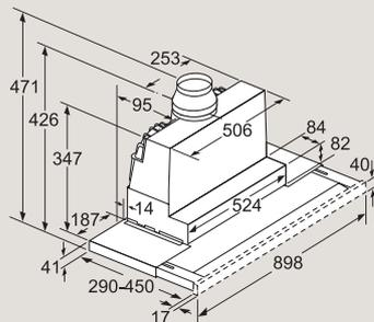
Tiefenanpassung des Filterauszuges bis 29 mm möglich
