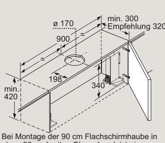
Bei Montage der 90 cm Flachschirmhaube in einen 90 cm breiten Oberschrank ist ein Montage-Set erforderlich. Die beiden Montagewinkel werden links und rechts im Möbel verschraubt. Montage nach Schablone.
