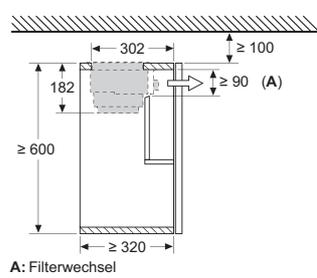
Montage Flachschildhaube mit Clean Air Modul und Absenkrahmen
