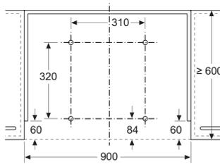
Montage Flachschrühhaube mit Absenkrahmen
