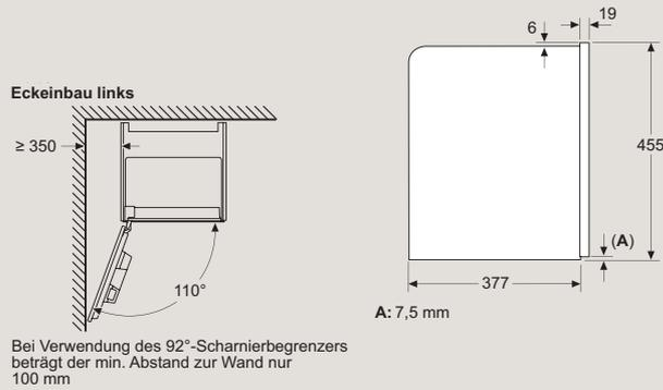
Bei Verwendung des 92°-Scharnierbegrenzers beträgt der min. Abstand zur Wand nur 100 mm
