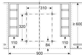
Montage Flachschrühhaube mit Absenkrahmen
