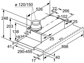
Tiefenanpassung des Filterauszuges bis 29 mm möglich
