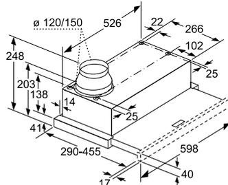
Tiefenanpassung des Filterauszuges bis 29 mm möglich
