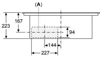
**Mode recyclage sans conduit d'installation (kit plug & play livré avec l'appareil)**
