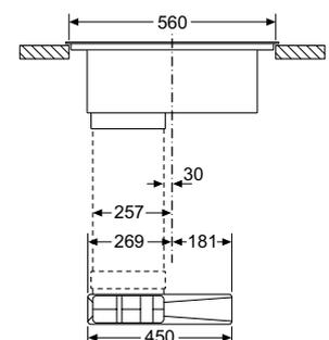
**Mode recyclage avec conduits d'installation jusque sous le meuble/à la plinthe**
