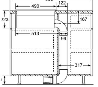
**Mode recyclage avec conduits d'installation jusque sous le meuble/à la plinthe**
