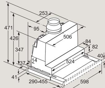
Tiefenanpassung des Filterauszuges bis 29 mm möglich
