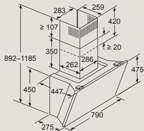
Gerät im Umluftbetrieb ohne Abluftkanal
