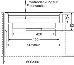
Frontabdeckung für Filterwechsel
