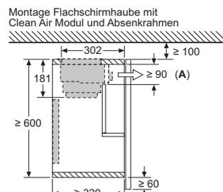
Montage Flachschrühhaube mit Absenkrahmen
