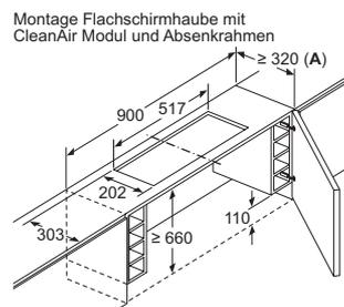
Montage Flachschrühhaube mit Absenkrahmen
