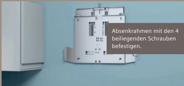
Absenkrahmen mit den 4 beiliegenden Schrauben befestigen.
