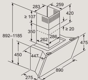
Gerät im Umluftbetrieb ohne Abluftkanal
