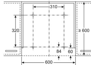
Montage Flachschriftmaube mit Absenkrahmen
