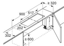
Einsatz eines Umluftsets bei Schränken mit Quertraverse (Lifttür) nicht möglich
