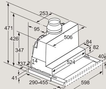
Tiefenanpassung des Filterauszuges bis 29 mm möglich
