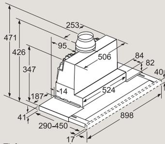
Tiefenanpassung des Filterauszuges bis 29 mm möglich
