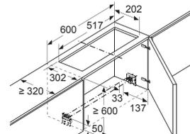
Einsatz eines Umluftsets bei Schränken mit Quertraverse (Lifttür) nicht möglich
