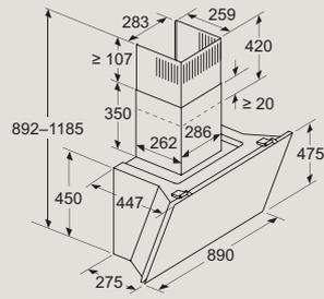
Gerät im Umluftbetrieb ohne Abluftkanal
