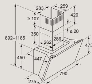
Gerät im Umluftbetrieb ohne Abluftkanal
