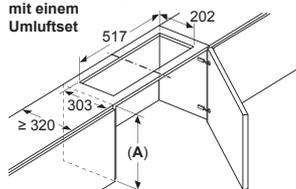
Einsatz eines Umluftsets bei Schränken mit Quertraverse (Lifttür) nicht möglich
