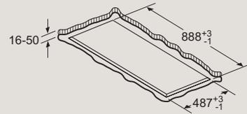
Nicht direkt in die Gipskartonplatte oder ähnliche Leichtbaustoffe der abgehängten Decke montieren. Geeignetes Untergerüst erforderlich, das fest in der Betondecke fixiert ist.
