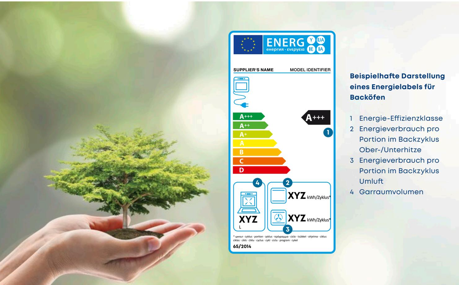
**Beispielhafte Darstellung eines Energielabels für Backöfen**
