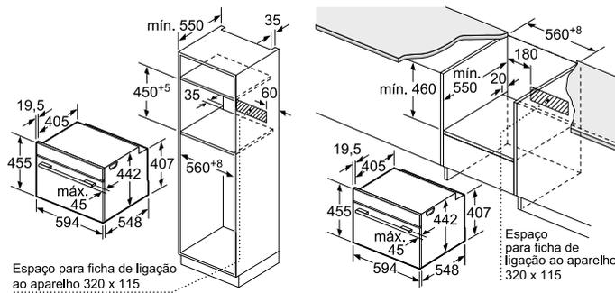
Instalação com uma placa de cozinhar.
