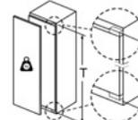
Portas do móvel montadas, que excedam o peso permitido, podem originar danos e falhas de funcionamento na dobradiça.
