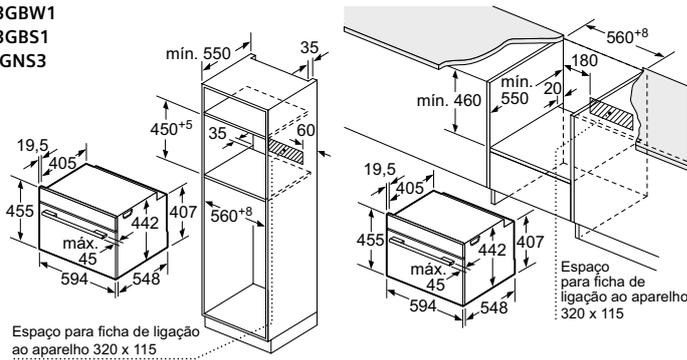
Instalação com uma placa de cozinhar.
