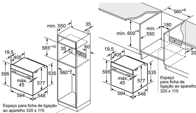
Instalação com uma placa de cozinhar.
