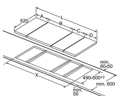
Para a montagem de dois ou vários elementos lado a lado são necessários um ou vários conjuntos de montagem (2 elementos - 1 conjunto de montagem, 3 elementos - 2 conjuntos de montagem, etc.).
