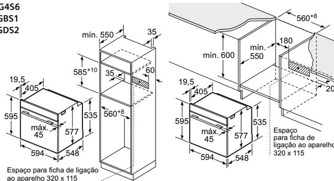
Instalação com uma placa de cozinhar.
