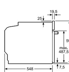
Instalação com uma placa de cozinhar.
