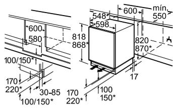
Espaço para ligação eléctrica na parte lateral direita ou à esquerda ao lado do aparelho. Entrada e saída de ar no rodapé.
