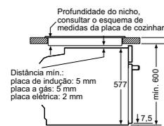
Se o aparelho for instalado por baixo de uma placa de cozinhar, tem de ser observada a seguinte espessura da bancada (se necessário incl. estrutura inferior).
