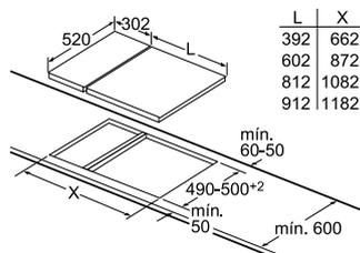
Para a instalação de um dominó diretamente ao lado de uma placa é necessário um conjunto para instalação (HZ394301).
