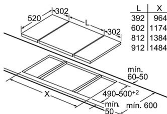
Para a instalação de dois dominós diretamente ao lado de uma placa são necessários dois conjuntos para instalação (HZ394301).
