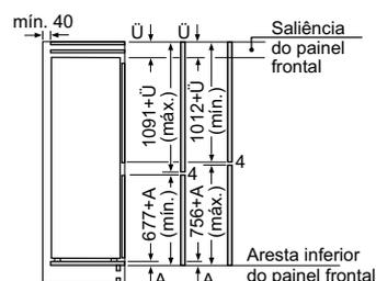
As medidas indicadas das portas dos móveis são válidas para uma junta de porta de 4 mm.
