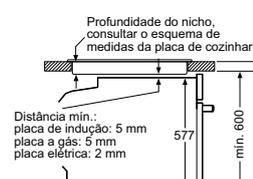
Se o aparelho for instalado por baixo de uma placa de cozinhar, tem de ser observada a seguinte espessura da bancada (se necessário incl. estrutura inferior).
