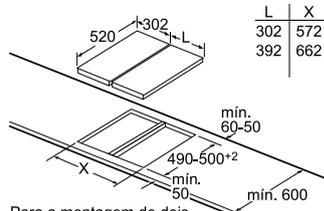
Para a montagem de dois ou vários elementos dominó directamente lado a lado são necessários um ou vários conjuntos de montagem (2 elementos - 1 conjunto de montagem, 3 elementos - 2 conjuntos de montagem, etc.).
