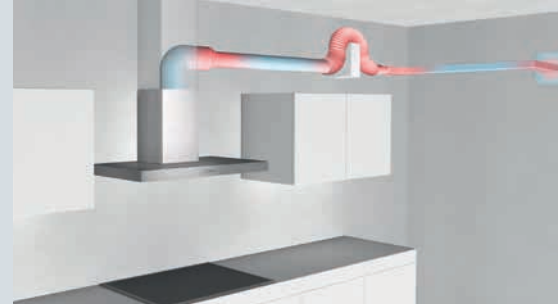
Beispiel einer schlechten Verrohrung
