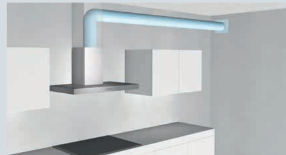
Beispiel einer guten Verrohrung
