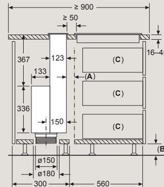
**A:** Fessura di ventilazione per piano cottura
