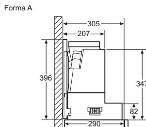
Montaggio apparecchi con telaio (X) di abbassamento - Profondità del mobile secondo la tabella delle combinazioni
