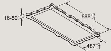
Non montare direttamente nel cartongesso o in altri simili materiali leggeri del controsoffitto. È necessaria una sottostruttura adeguata fissata saldamente nel soffitto in calcestruzzo.
