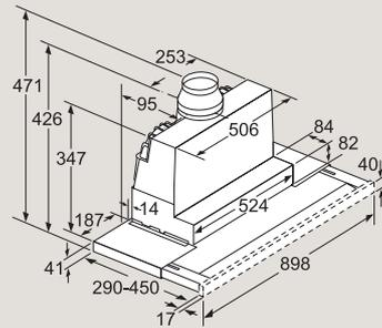
Regolazione in profondità dell'estensione del filtro possibile fino a 29 mm
