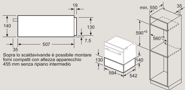
Sopra lo scaldavivande è possibile montare forni compatti con altezza apparecchio 455 mm senza ripiano intermedio
