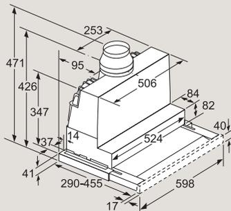
Regolazione in profondità dell'estensione del filtro possibile fino a 29 mm
