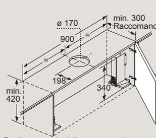
Per il montaggio della cappa a schermo piatto da 90 cm in un pensile di 90 cm di larghezza è necessario un set di montaggio. Le due staffe di montaggio vanno avvitate nel mobile a sinistra e a destra. Montaggio secondo la sagoma.
