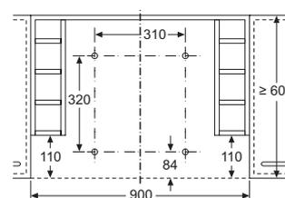
Montaggio cappa a schermo piatto con telaio di abbassamento
