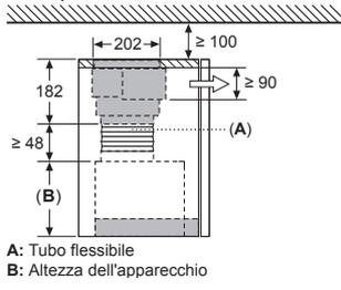
**Montaggio del modulo ventilatore con set a ricircolo d'aria**
