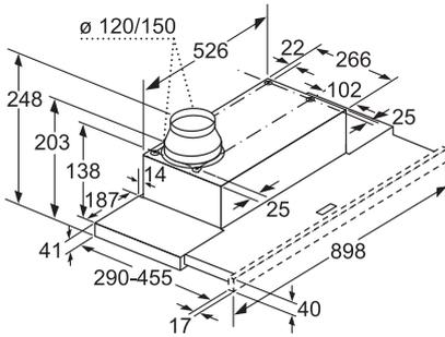
Tiefenanpassung des Filterauszuges bis 29 mm möglich
