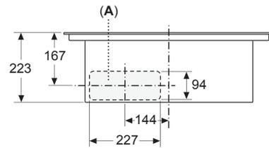
**A:** Direkt an der Rückseite angeschlossen
