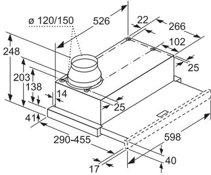
Tiefenanpassung des Filterauszuges bis 29 mm möglich
