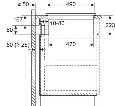
Bei der Installation direkt an einer nicht isolierten Außenwand ( $\mu \geq 0,5 \text{ W/m}^2 \cdot \text{°C}$ ) empfehlen wir die Verwendung von Konfigurationen mit teilweise oder vollständig kanalisierter Rezirkulation.
