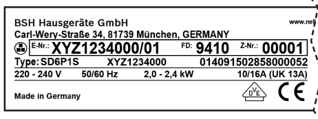
Beispiel des Typenschildes mit E-Nr. und FD
