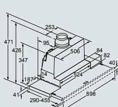
Adattamento della profondità del filtro estraibile possibile fino a 29 mm
