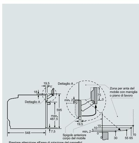
Montaggio con un piano di cottura.
