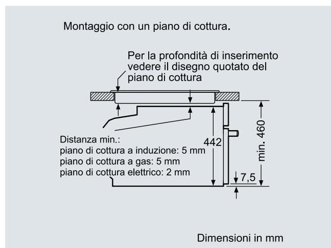
Se l'apparecchio compatto viene montato sotto un piano di cottura deve essere rispettato il seguente spessore del piano di lavoro (event. incl. sottostruttura).
