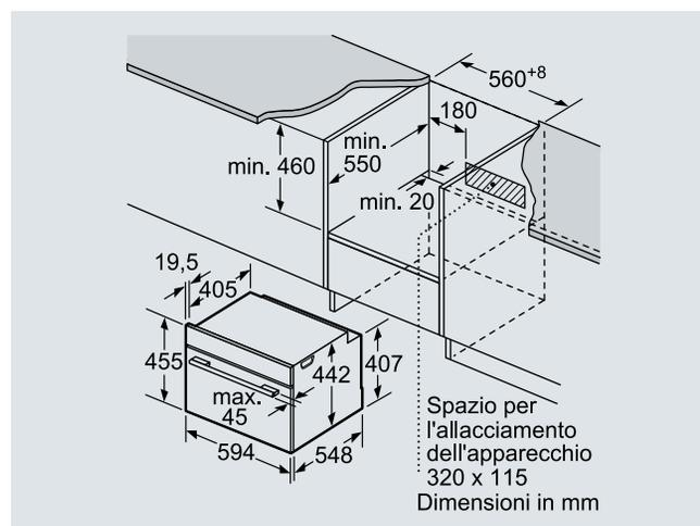
In caso di apparecchi con microonde, aerazione nello zoccolo min. 50 cm<sup>2</sup>
