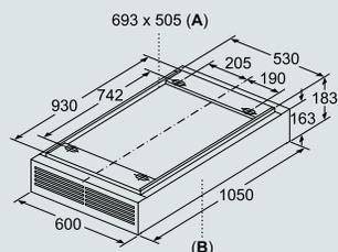
A: area per l'apertura per il cavo sul soffitto
