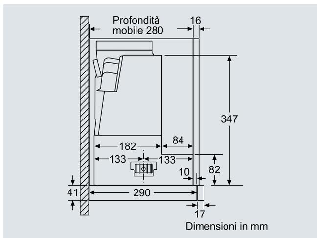
La mascherina della cappa può essere montata a filo con l'anta del mobile solo se il corpo dell'apparecchio è profondo 305 mm.
