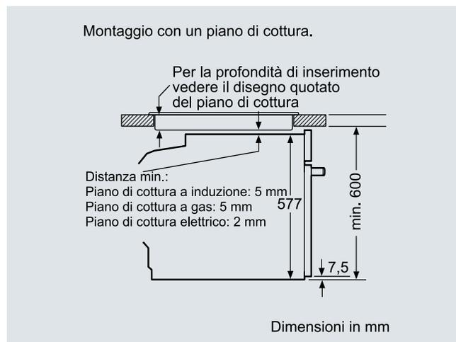
Se l'apparecchio viene montato sotto un piano di cottura deve essere rispettato il seguente spessore del piano di lavoro (event. incl. sottostruttura).
