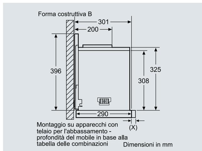
Tabella delle combinazioni per apparecchi da 60 cm con telaio per l'abbassamento
