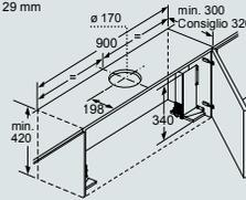
Per il montaggio della cappa piatta da 90 cm in un pensile da 90 cm è necessario un set di montaggio. Entrambi gli angolari di montaggio vengono avvitati a sinistra e a destra nel mobile. Montaggio in base alla mascherina.
