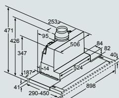
Adattamento della profondità del filtro estraibile possibile fino a 29 mm
