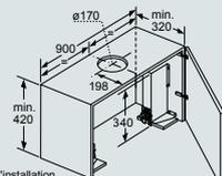
L'installation d'une hotte tiroir de 90 cm dans un meuble haut d'une largeur de 90 cm requiert un kit d'installation. Les deux équerres d'installation sont vissées à droite et à gauche dans le meuble. Installation selon gabarit.
