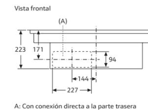
Esquema de instalación en recirculación con canalización parcial o total
