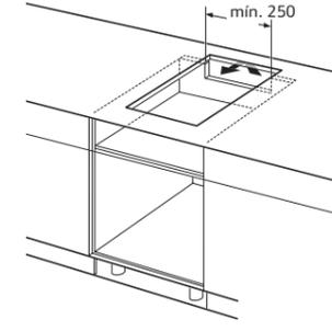
**Nota para la instalación eléctrica de placas de inducción:** este aparato en su funcionamiento normal produce corriente de fuga en alta frecuencia. La corriente de fuga en las instalaciones puede estar limitada por un diferencial.
