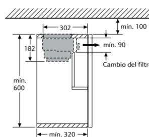
Montaje de la campana telescópica con módulo set de recirculación de alta eficiencia
