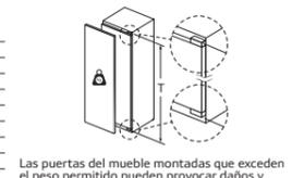
Las puertas del mueble montadas que exceden el peso permitido pueden provocar daños y deterioro funcional a la bisagra.
