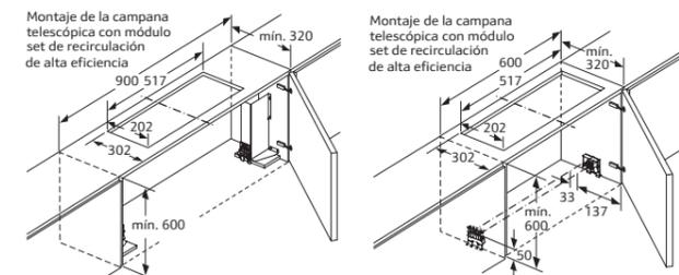
La instalación del módulo set de recirculación de alta eficiencia no es posible en caso de armarios con travesaños (puerta elevable).
