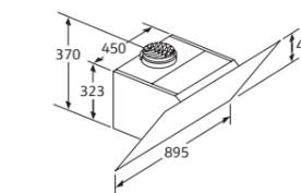
Aparato en recirculación de aire sin conducto. Será necesario un set de recirculación de aire.
