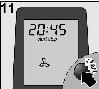
□ Drukken op de toets voor aanzetten "start" of uitzetten "stop": op de display zal knipperend de gekozen optie verschijnen, alsmede de waarden behorend bij de laatste programmering van de tijdschakelaar, Fig. 11.
