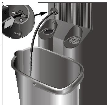
□ Dans des conditions extrêmes d'humidité, l'appareil accumule de l'eau condensée dans un réservoir interne. Lorsqu'elle arrive à un certain niveau, un pilote de signalisation avec une lumière rouge clignotante s'allume, pour indiquer la nécessité de vider ce réservoir, à l'aide du tuyau d'évacuation accouplé à l'ouverture de la partie inférieure de l'appareil.
