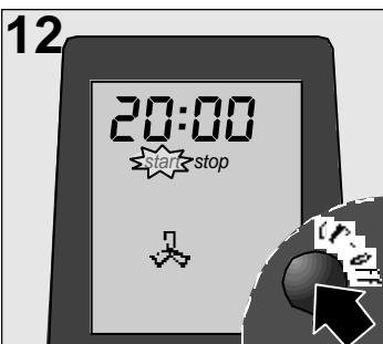
□ Gedurende twee seconden drukken op de toets voor het Aanzetten / Uitzetten (**start / stop**). De gekozen optie (**start / stop**) verdwijnt van de display.
