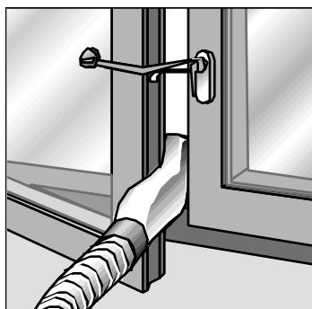
□ Abbinate il manicotto diffusore al tubo espulsore dell'aria calda.
