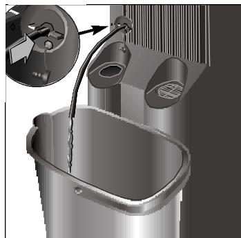
□ In condizioni estreme di umidità, l'apparecchio accumulerà acqua condensata in un serbatoio interno. Raggiunto un determinato livello, si accenderà la spia di indicazione con la luce rossa lampeggiante, indicando il bisogno di svuotare il suddetto serbatoio, con l'aiuto del tubo di scarico, collegato all'attacco nella parte inferiore dell'apparecchio.
