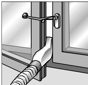
□ Accouplez le manchon de diffusion au tuyau d'expulsion d'air chaud.
