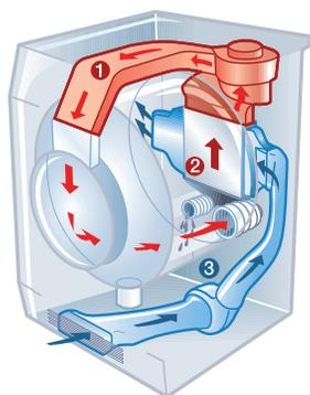
Porque condensan la humedad con aire frío del exterior sin necesidad de agua, ahorrando miles de litros al año comparado con una lavadora-secadora convencional.
