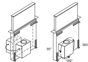
L'unité moteur peut être tournée sur n'importe lequel de ses quatre côtés, et peut être montée sur sa face avant ou arrière.
