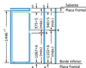
Las dimensiones dadas de la puerta del mueble corresponden a una junta de puerta de 4 mm. Si se utiliza un ancho de la junta diferente (máx. 14 mm) deben adaptarse las medidas.
