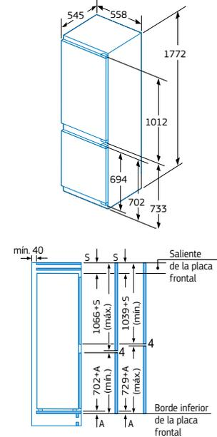
Las dimensiones de la puerta del mueble indicadas corresponden a una junta de puerta de 4 mm.
