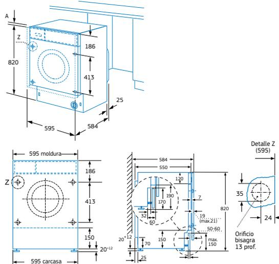
Posibilidad de intercambiar la fijación de la puerta del mueble a izquierda o derecha.
