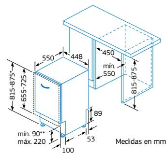
\* Mediante patas regulables en altura.
