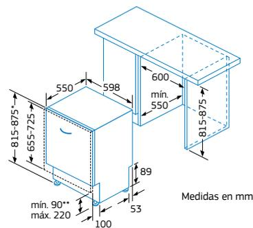
\* Mediante patas regulables en altura.
