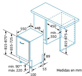
\* Mediante patas regulables en altura.
