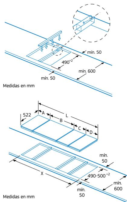
Foto correspondiente a la tabla de combinaciones de placas y sus correspondientes dimensiones de encastre.
