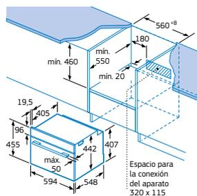
Si se instala el aparato compacto debajo de una placa, se debe respetar el siguiente grosor de encimera (incl., dado el caso, la estructura de soporte).
