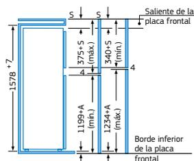
Las dimensiones de la puerta del mueble corresponden a una junta de puerta de 4 mm. Si se utiliza una junta de un ancho diferente (máx. 14 mm) deben adaptarse las medidas.
