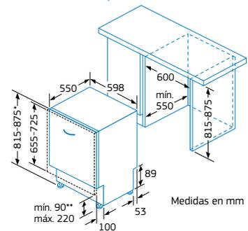
\* Mediante patas regulables en altura.
