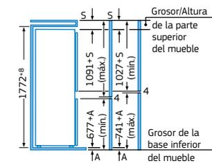
En medidas superiores (1780-1790) se debe tener en cuenta el listón distanciador del hueco. Las dimensiones de la puerta del mueble corresponden a una junta de puerta de 4 mm. Si se utiliza una junta de un ancho diferente (máx. 14 mm) las medidas deben adaptarse.
