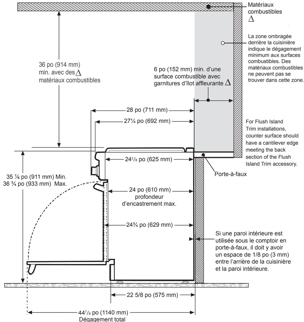
$\Delta$  tel que défini dans le « National Fuel Gas Code » (ANSI Z223.1, édition actuelle). Les dégagements pour matériaux non-combustibles ne sont pas abordés dans la norme ANSI Z21.1 ni certifiés par la CSA. Un dégagement de moins de 6 po (152 mm) doit être conforme aux codes locaux et/ou approuvé par les autorités locales ayant juridiction.
