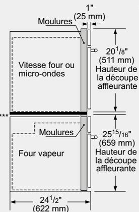
\*\*\* Pour un montage affleurant, une plaque de socle est requise sous le boîtier : 30" Dimensions du produit : H 5<sup>1</sup>/<sub>16</sub>" (8 mm) x L 28<sup>1</sup>/<sub>2</sub>" (724 mm) x P 22<sup>1</sup>/<sub>2</sub>" (571 mm)
