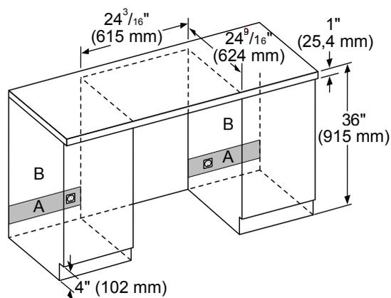
A : zone recommandée pour le raccordement de l'installation - un trou d'un diamètre de 2<sup>1</sup>/<sub>2</sub>" (63 mm) est conseillé.
