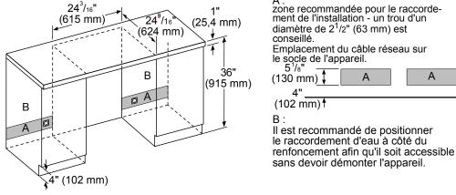
Pour une installation affleurante, il est recommandé de positionner la sortie et le raccordement d'eau sur le côté de l'unité et non directement derrière.
