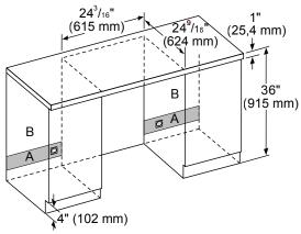
A: zone recommandée pour le raccordement de l'installation - un trou d'un diamètre de 2<sup>1</sup>/2" (63 mm) est conseillé. Emplacement du câble réseau sur
