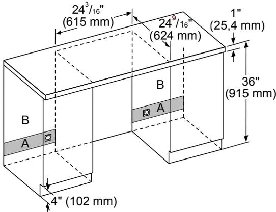
A : zone recommandée pour le raccordement de l'installation - un trou d'un diamètre de 2 1/2" (63 mm) est conseillé.
