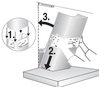
13. Levantar ligeramente el elemento superior del revestimiento de la chimenea y fijarlo lateralmente, con ayuda de dos tornillos, a la escuadra de soporte.
