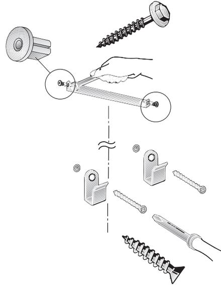
7. Dunstabzugshaube einhängen. Höhe und waagerechte Lage mit den Verstellerschrauben ausrichten.
