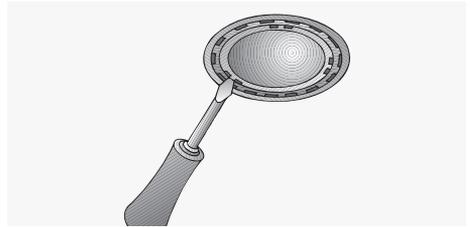
3. Changez l'ampoule halogène (ampoule halogène en vente habituelle dans le commerce, 12 volts, 20 watts maxi., douille G4).
