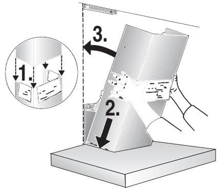
13. Den oberen Teil anheben und mit 2 Schrauben seitlich an den Haltewinkel schrauben.
