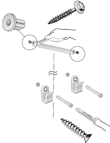
7. Enganchar la campana extractora. Ajustar la altura y la posición horizontal de la misma con ayuda de los tornillos de ajuste.
