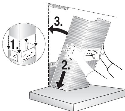
13. Levantar ligeiramente a parte superior e aparafusá-la lateralmente com dois parafusos no ângulo de retenção.
