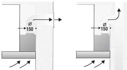
El aire de evacuación pasa a través de un túnel de ventilación hacia arriba o directamente hacia el exterior, a través de la correspondiente pared.
