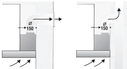
L'air vicié est évacué vers le haut par un conduit d'aération ou directement à l'air libre par traversée du mur extérieur.
