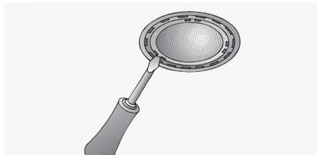
3. Substituir a lâmpada de halogéneo (lâmpada de halogéneo corrente no mercado, 12 Volt, máx. 20 Watt, casquilho G4).
