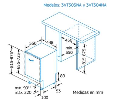
\* Mediante patas regulables en altura.
