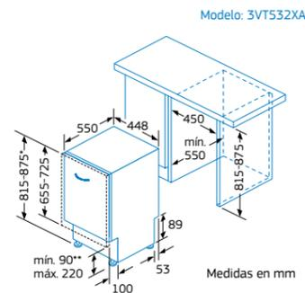
\* Mediante patas regulables en altura.
