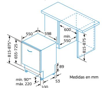
\* Mediante patas regulables en altura.
