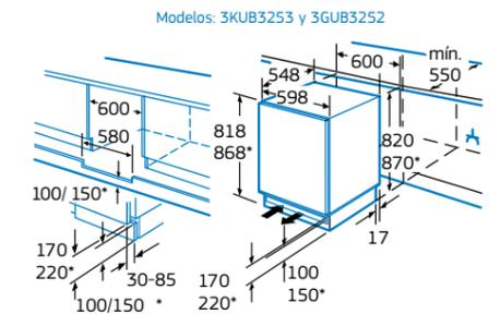
Espacio para conexión eléctrica lado derecho o izquierdo junto al aparato. Ventilación del zócalo.
