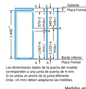
Las dimensiones dadas de la puerta del mueble corresponden a una junta de puerta de 4 mm. Si se utiliza un ancho de la junta diferente (máx. 14 mm) deben adaptarse las medidas.
