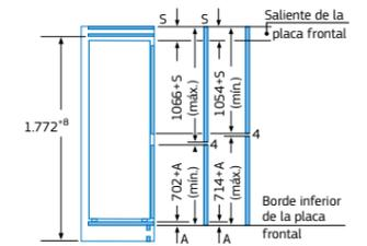
Las dimensiones de la puerta del mueble corresponden a una junta de puerta de 4 mm. Si se utiliza una junta de un ancho diferente (máx. 14 mm) deben adaptarse las medidas.
