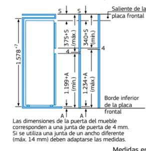
Las dimensiones de la puerta del mueble corresponden a una junta de puerta de 4 mm. Si se utiliza una junta de un ancho diferente (máx. 14 mm) deben adaptarse las medidas.
