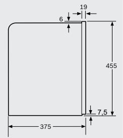
Si se usa el límite de 92° de la bisagra (pieza de recambio n.º 00636455), la distancia mínima hasta la pared es de solo 100 mm.
