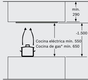
Para fijar la campana extractora se requiere una estructura inferior apta y resistente. No montar el aparato directamente sobre tablas de yeso o materiales ligeros similares.
