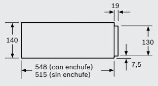
Los hornos compactos con una altura de 455 mm se pueden montar sobre un módulo de calentamiento. No es necesaria una balda intermedia.
