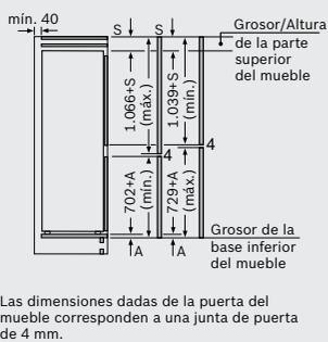
Las dimensiones dadas de la puerta del mueble corresponden a una junta de puerta de 4 mm.
