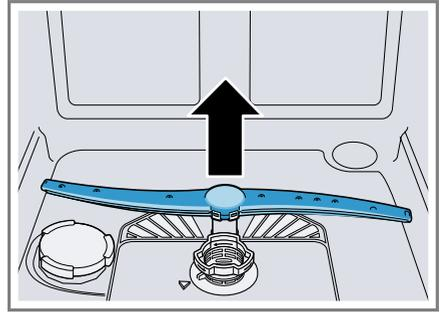
6. Unter fließendem Wasser die Austrittsdüsen der Sprüharme auf Verstopfungen prüfen und gegebenenfalls Fremdkörper entfernen.
