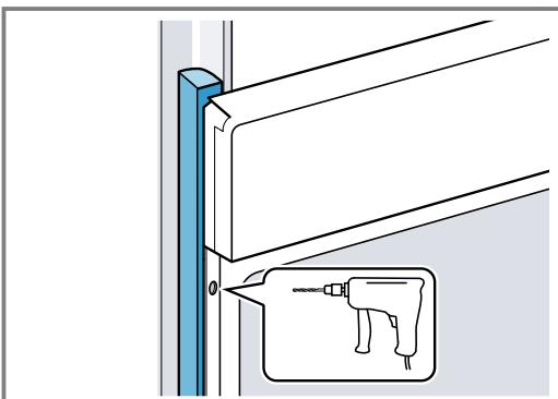
4. Das Gerät mit adäquater Schraube befestigen.
