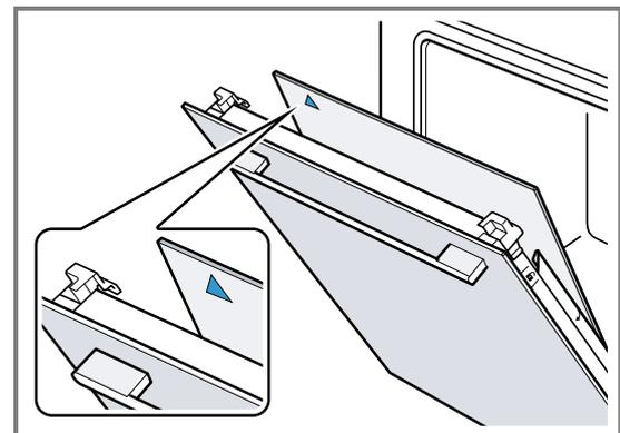
1. Die erste Zwischenscheibe in die unterste Halterung einschieben ① und oben anlegen.
