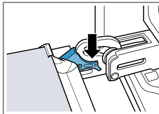
✓ Die Sperrhebel sind zugeklappt. Die Gerätetür ist gesichert und kann nicht ausgehängt werden.
