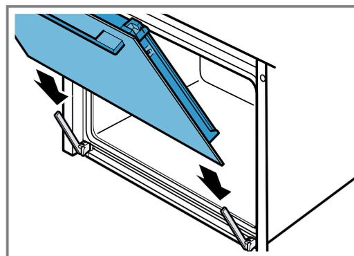
2. Mit beiden Händen die Gerätetür bis zum Anschlag schieben.
