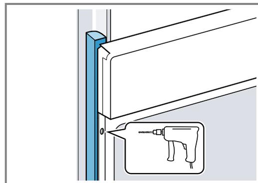
4. Das Gerät mit adäquater Schraube befestigen.
