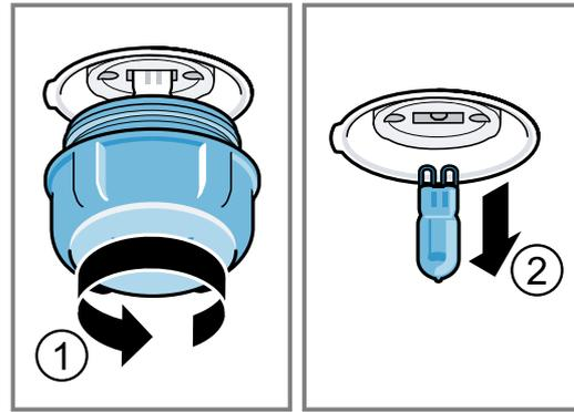
4. Colocar y presionar firmemente en el enchufe la lámpara halógena. Atención a la posición de los pines.
