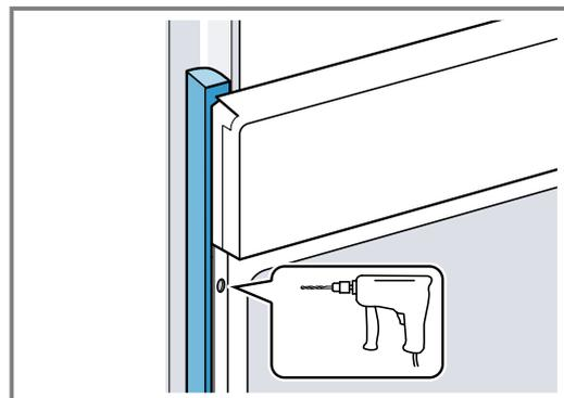
4. Das Gerät mit adäquater Schraube befestigen.
