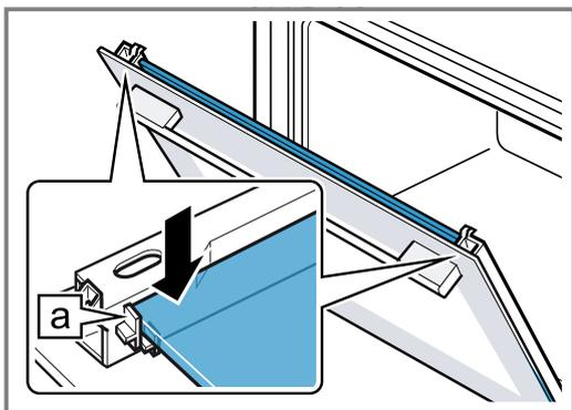
5. Die Gerätetür öffnen und Türdichtung einhängen.
