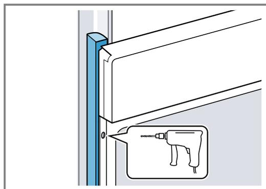
4. Das Gerät mit adäquater Schraube befestigen.
