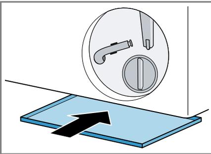
6. Den Entleerungsschlauch aus der Halterung nehmen.
