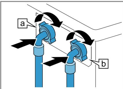
2. Den Wasserzulaufschlauch für Warmwasser **a** (rot) und Kaltwasser **b** (blau) am Wasserhahn (26,4 mm = 3/4") anschließen.
