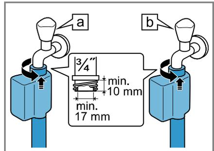
Wenn Wasser kein vorhanden ist, nur den Wasserzulaufschlauch für Kaltwasser anschließen. Den Warmwasseranschluss am Gerät abdecken, um ihn vor Verschmutzung zu schützen.
