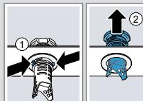
5. Unter fließendem Wasser die Siebelemente reinigen.
