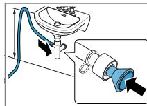
Odtokovou hadici upevněte pomocí držáku hadice ve výšce minimálně 80 cm a maximálně 100 cm.
